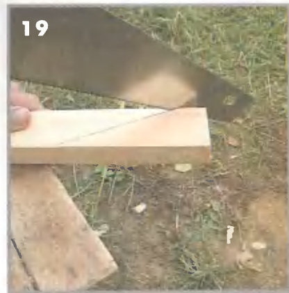
18, 19. Подготовка накладок. Сначала сделайте разметку, а потом отрежьте заготовки по контурным линиям
