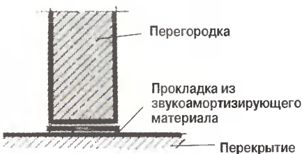
Рис. 4. Изоляция перегородок от перекрытий
