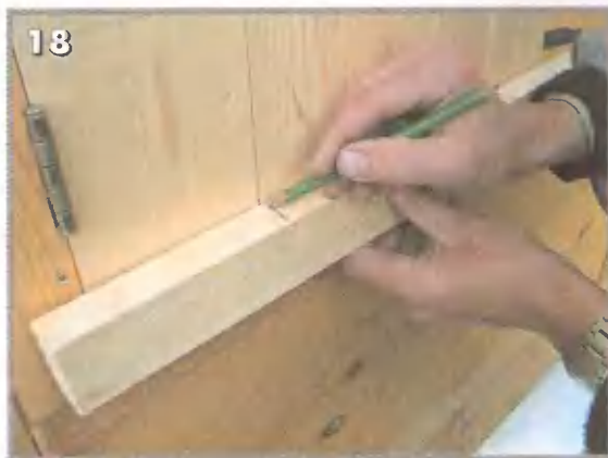
18, 19. Подготовка накладок. Сначала сделайте разметку, а потом отрежьте заготовки по контурным линиям
